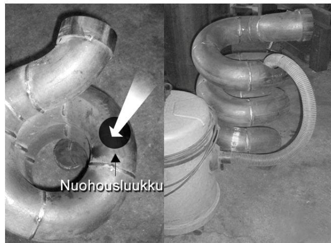
Kuva 2 Suorita nuohous taipuisalla nailonharjalla tai vaihtoehtoisesti esim. teollisuusimurin avulla.
